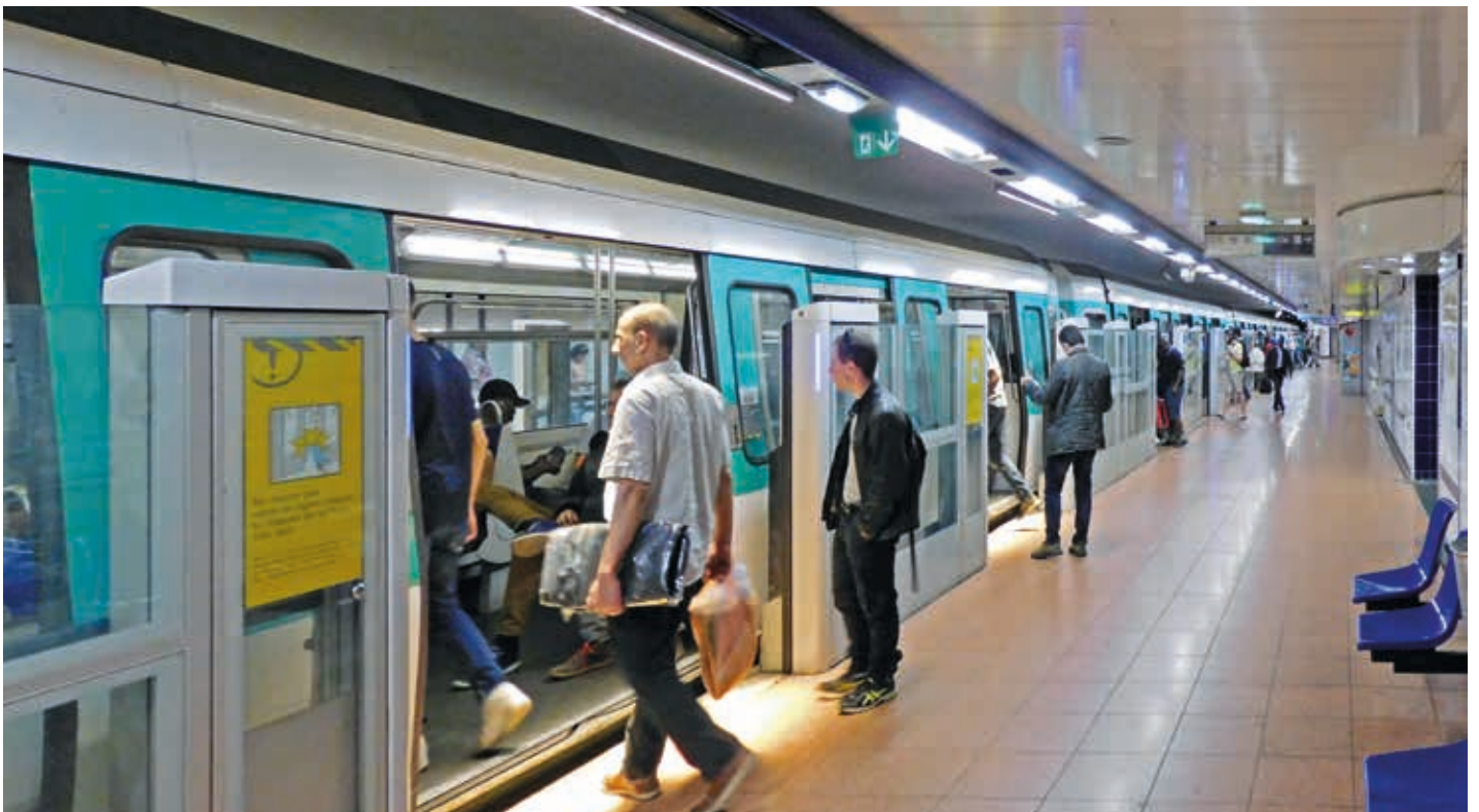
Bild 8 – Paris Metro Linie 13 – Seit 1977 halbautomatische Zugsteuerung – Bahnsteigbreite 5,20 Meter mit Bahnsteigtüren
