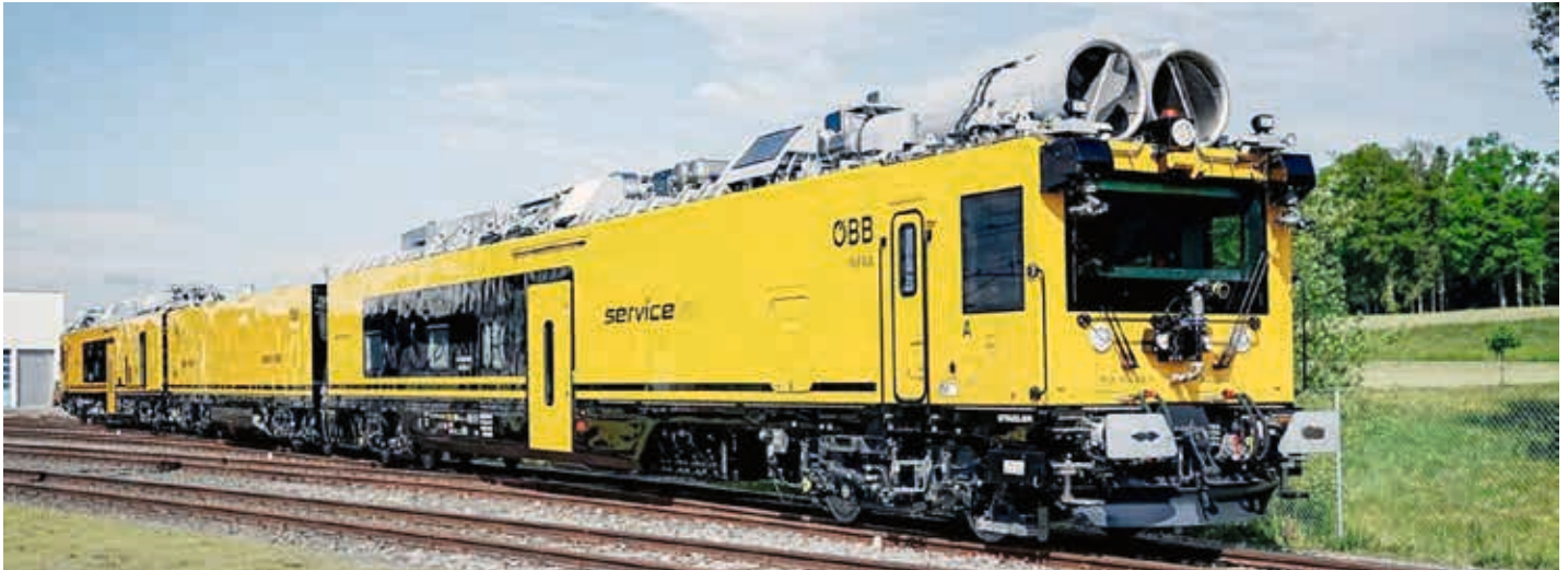
Bild 05 – Moderner Evakuierungs- und Löschzug der Firma Stadler und bereits im Einsatz bei den Österreichischen Bundesbahnen (ÖBB)
