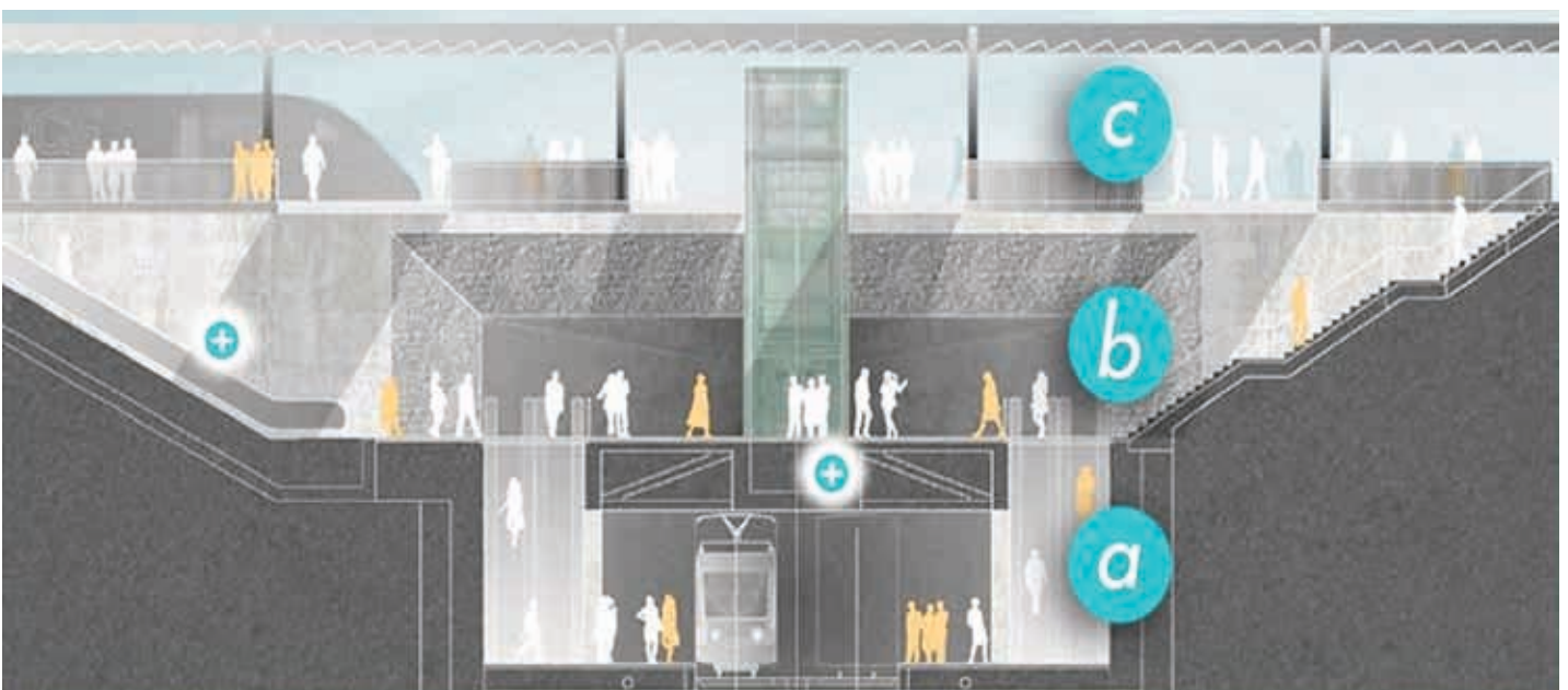
Bild 04 – Augsburger Straßenbahntunnel: In Hamburg a = Untergeschoss 4 neue Gleise, b = Zwischenebene und c = Bestandsgleise
